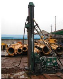
复合锚杆施工机械设备
